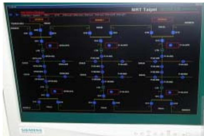
圖十二、新的淡水新店線 PRC 畫面盡量做到與舊有畫面相同，以避免操作上困擾
