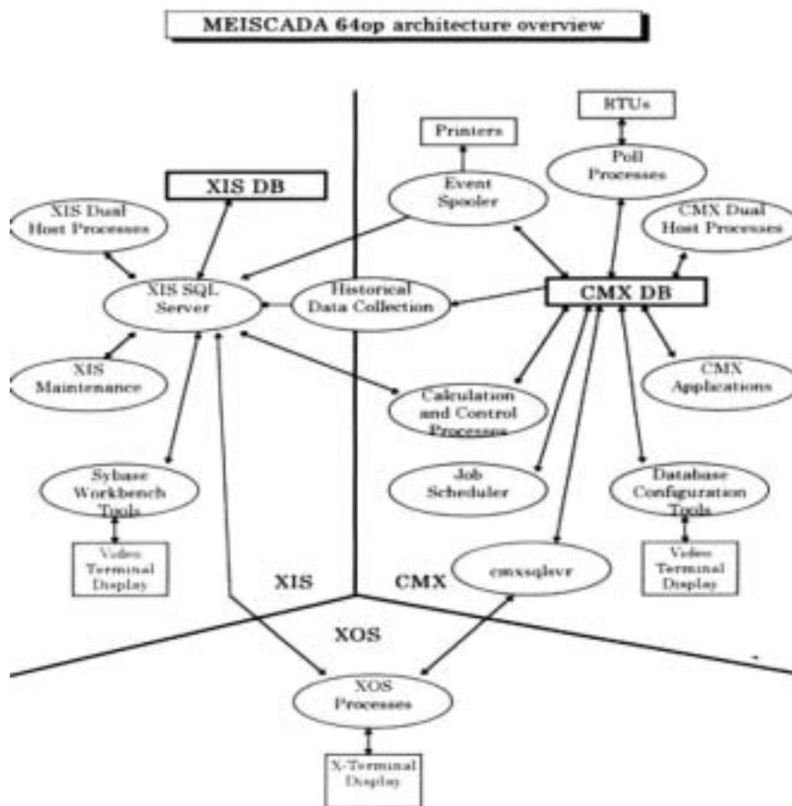
圖十五、明電舍軟體架構示意圖
