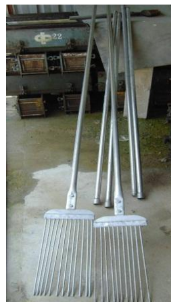
圖 24 長線鋁筴排氣工具
