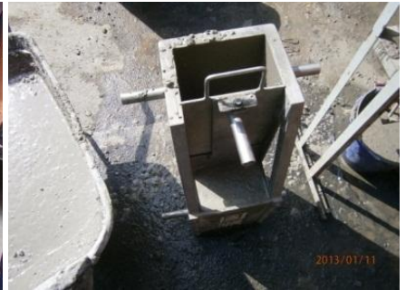
圖 15 箱型充填高度試驗
