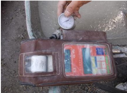
圖 16 混凝土溫度、氯離子含量試驗
