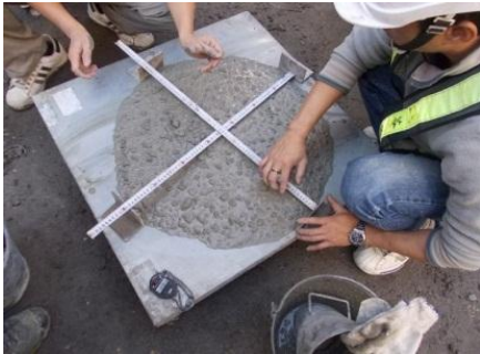
圖 13 坍流度流動性試驗
