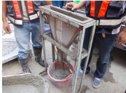
圖 14 V 型漏斗抗析離性試驗
