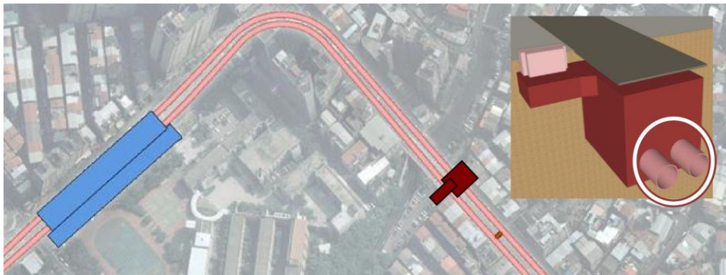
圖 14 替代案通風豎井配置示意圖
