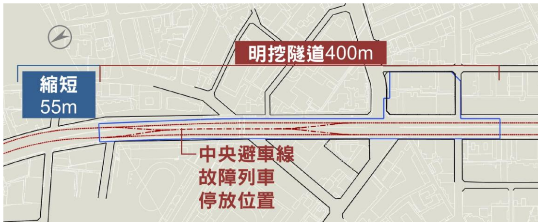
圖 10 替代案：中央避車線及 9 號道岔
