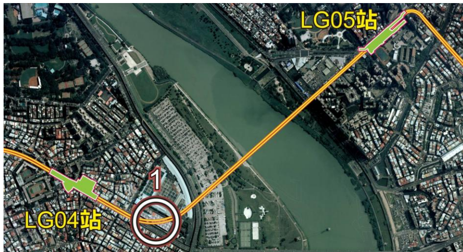
圖 6 替代案調整後平面線形(一組曲線)
