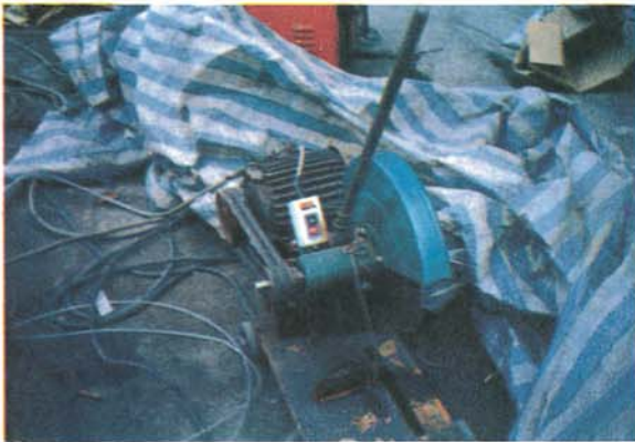
↓圖四：置於露天之機具均使用防水性佳之按鈕開關，防止勞工感電
