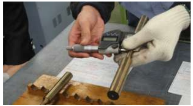
圖 18 試體拉伸長度量測
