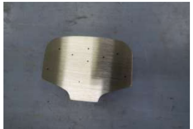
圖 8 硬度測試施壓完成試體
