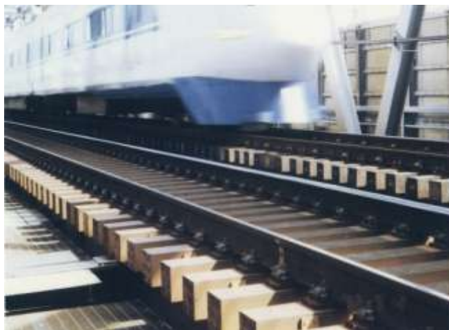
圖 43 日本東海道新幹線的所有橋樑及道岔位置使用 FFU 合成軌枕
