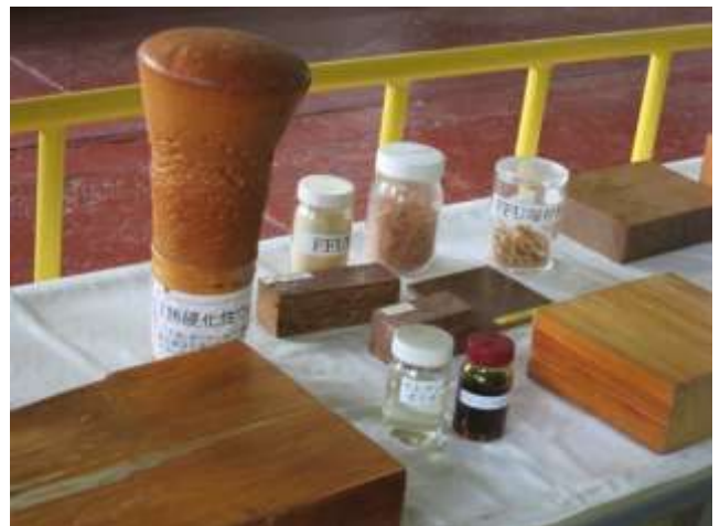
圖 37 為硬質聚氨樹脂原料及發泡體
