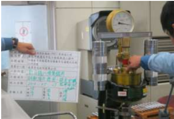
圖 7 硬度測試加壓情形
