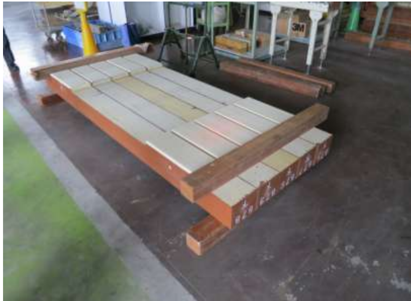
圖 40 FFU 合成枕木可依客戶需求加工
