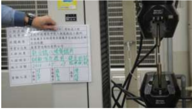
圖 17 拉伸試驗測試情形 2
