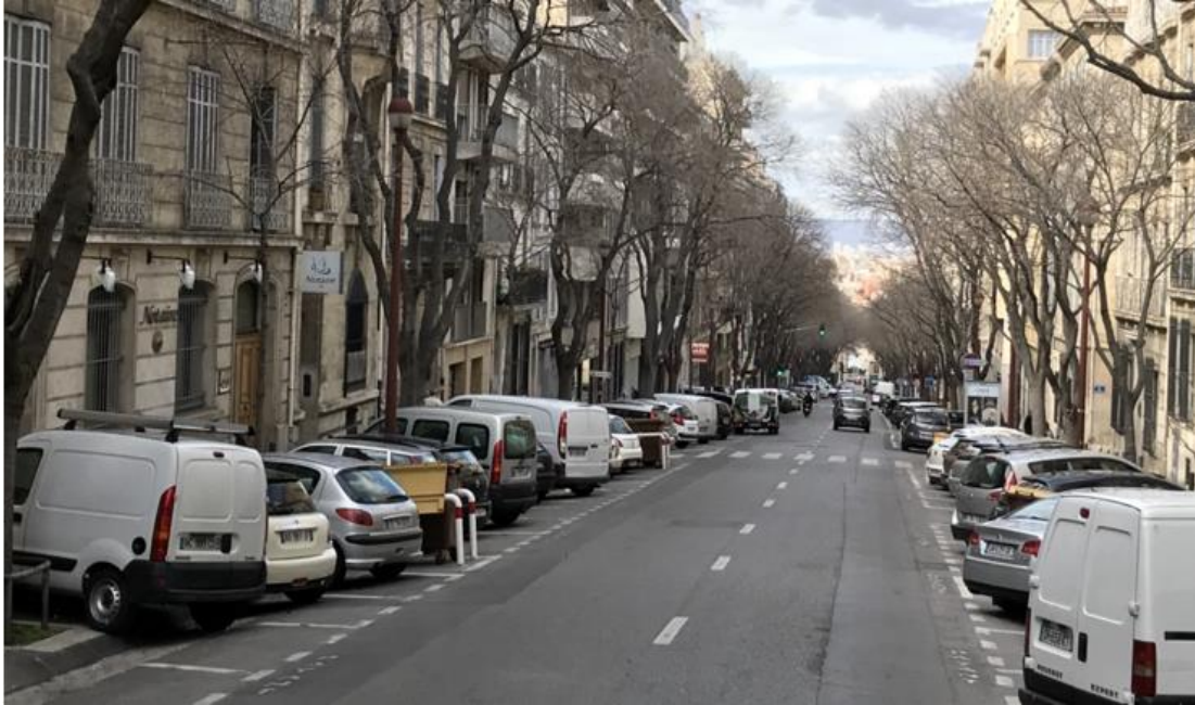
圖 20 馬賽市區斜向停車格設計適用於路面較寬廣道路，主要功能在使停車輛增加
