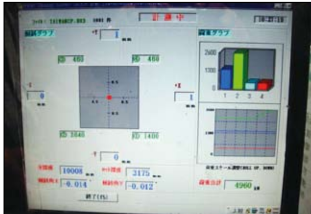
圖25 壓入管理監測畫面
