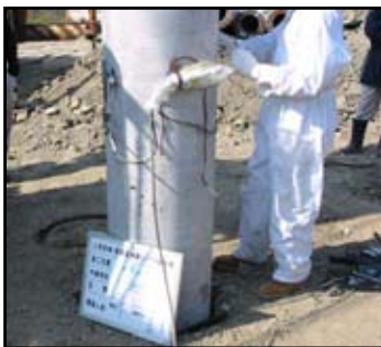
圖27 PC樁PDA(完整性)檢驗
