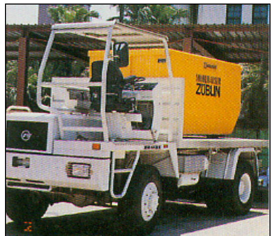
圖 9 C201A 隧道工程車
