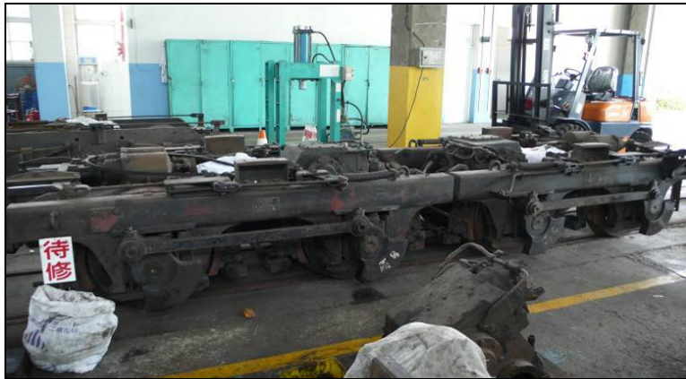
圖 16 阿里山鐵道修理工廠內將拆下之堪用零件改裝至其他待修車輛上（筆者攝於嘉義市）
