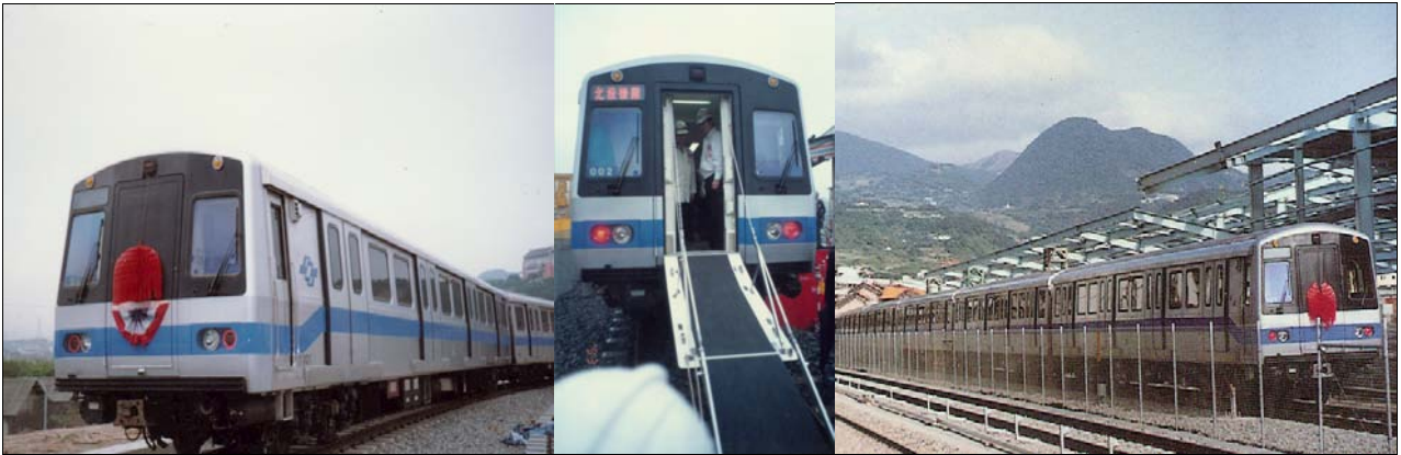
圖 5(由左至右)臺北捷運淡水線第一部電聯車、逃生門測試及原型車於北投機廠測試軌測試
