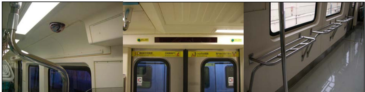
圖 3 新蘆線車廂設施(自左而右)CCTV 攝影機、到站顯示器、DM1 車廂行李架
