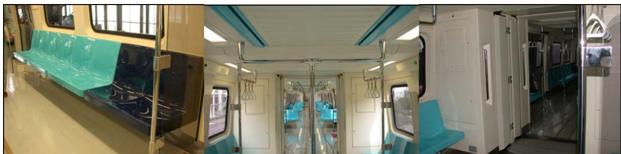
圖 4 新蘆線車廂設施(自左而右)DM1 車廂直式座椅、車門走道 T 型扶手、車間走道扶手
