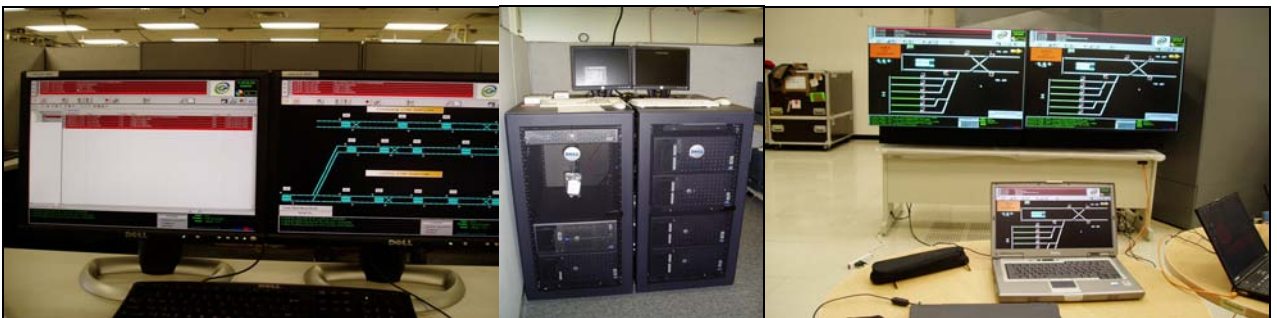
圖 16 未來交九行控中心設備(自左而右)控制員監控畫面、主電腦設備、後投式顯示板
