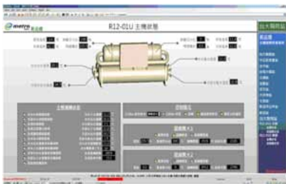
▲圖10 冰水主機連線系統操作頁面
