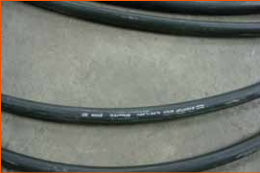
▲圖15 具LSFH被覆、XLPE絕緣電源線
