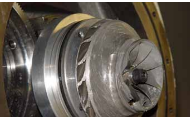
▲圖1 離心式冰水機壓縮機之葉輪損壞情形
