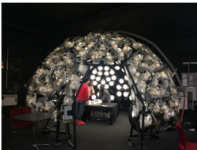
圖 1：系上的人造天球光源，提供模擬天空光實驗之用
