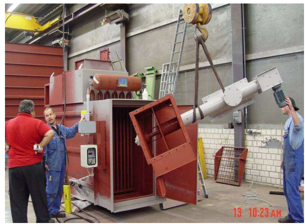
廠驗人員檢視除塵設備組裝情形
