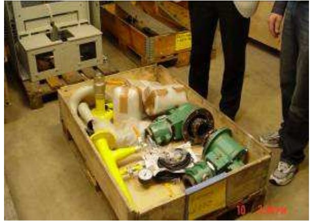
檢視火葬爐燃燒機組件
