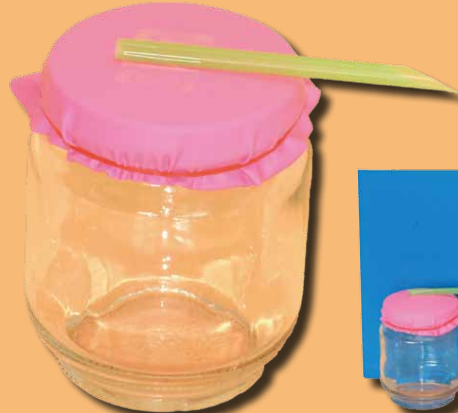
3. 吸管的一端用膠帶黏在氣球上，另一端剪一個斜斜的切口。
