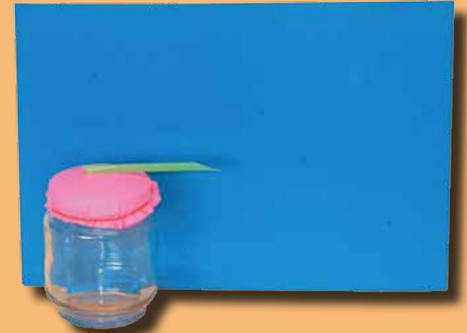
4. 將玻璃瓶靠在一張厚紙板上，用雙面膠帶固定。當外界的氣壓低時，會將氣球向上鼓起，使吸管下垂。
