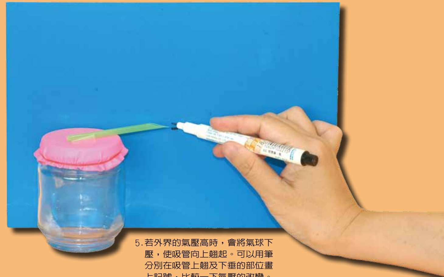
4. 將玻璃瓶靠在一張厚紙板上，用雙面膠帶固定。當外界的氣壓低時，會將氣球向上鼓起，使吸管下垂。
