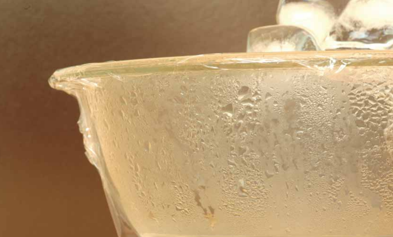
3. 觀察是不是有水滴凝結在玻璃碗及保鮮膜內側？這是水蒸氣上升，遇到較冷的玻璃碗及保鮮膜凝結成水滴，然後較重的水滴就會往下落。實驗結果就是大自然中雲和雨的形成原因。
