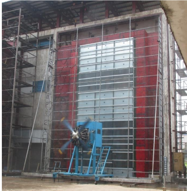
照片 7：帷幕牆風雨試體動態水密性試驗過程
