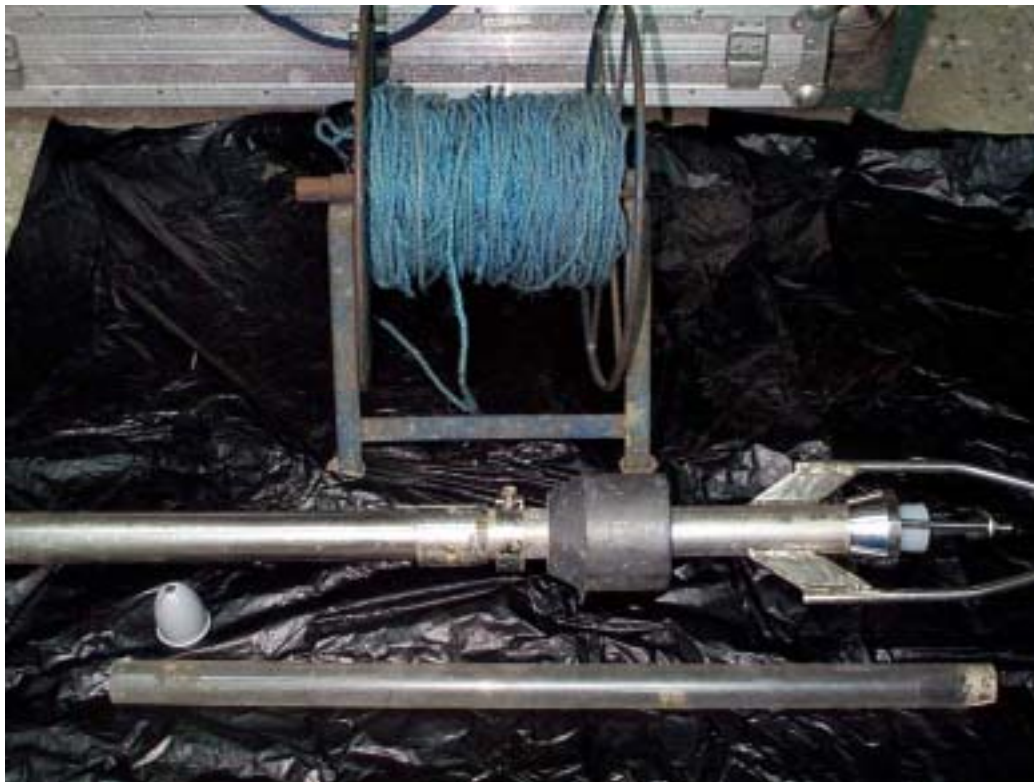
圖 3.2 貫入式之套管底泥採樣器
