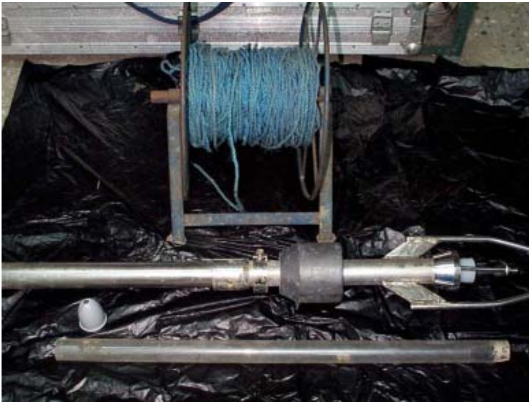
圖 3.3 貫入式之套管底泥採樣器
