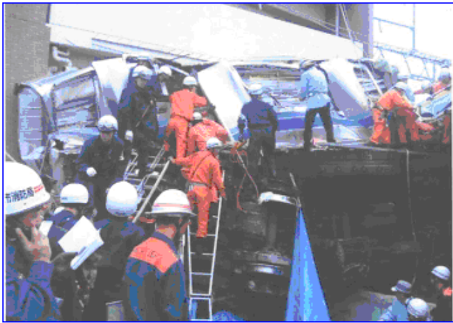
圖 7：第 2 節車廂粘貼於大樓外 側成 L 型損壞情形
