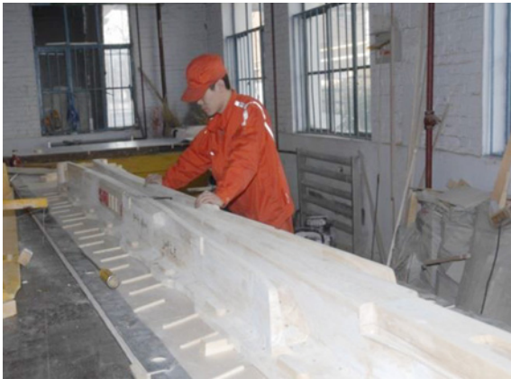
圖2 岔心模型製作
