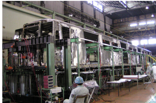
圖 7、車體結構強度測試
