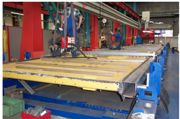
圖 2、車體底架組件焊接
