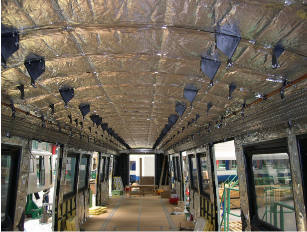
圖 3、電聯車天花板扣接件組裝
