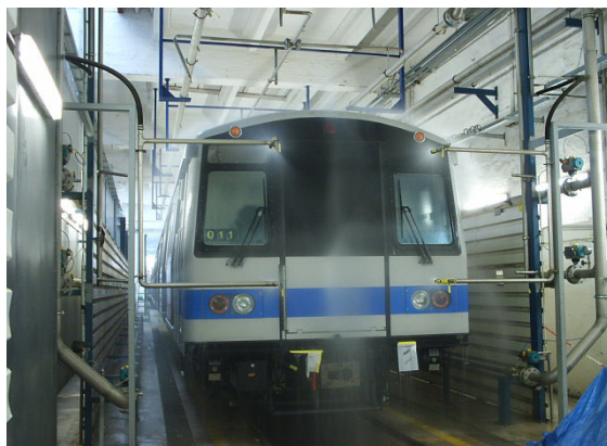
圖 9、車體水密測試 (完成組裝後出廠前)
