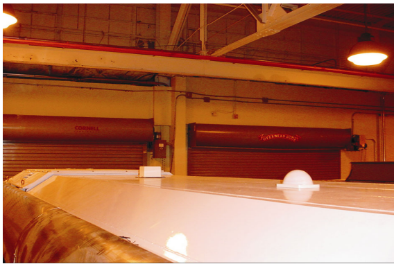
圖 9 內湖車輛之車頂天線設備
