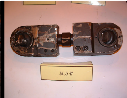
圖 3 扭力臂固定螺栓斷裂處
