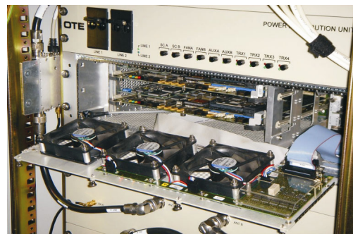
圖 3、無線電基地台板件配置
