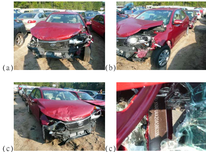
圖 5-1 事故現場車損情形拍照紀錄（a：車輛正面車損情形；b：車輛左前方車損情形；c：車輛右前方車損情形；d：事故車輛的 VIN number）
