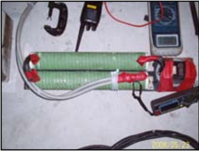
圖31 1.2Ω/1kw功率電阻器 (自製) 及三用電錶
