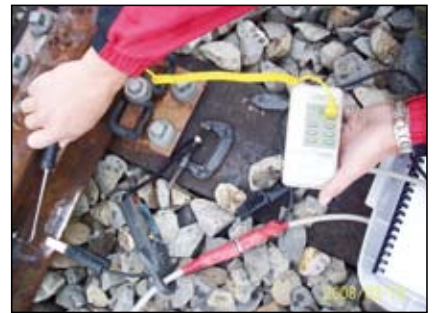
圖41 鋼軌溫度量測
