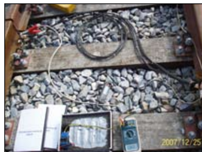
圖43 鋼軌對地電阻測試 (測試端)
