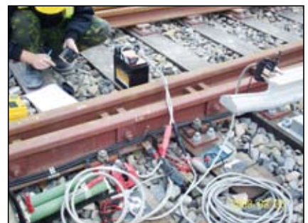
圖47 導電軌/鋼軌連續性測試(測試端)
