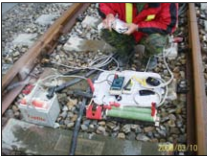
圖39 鋼軌直流電阻測試 (測試端)
