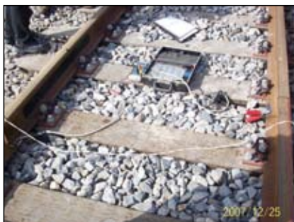
圖42 鋼軌/鋼軌電阻測試
