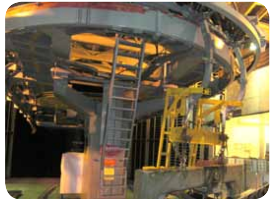
▲ 圖 1 雙握索器運具通過場站水平轉彎區域
