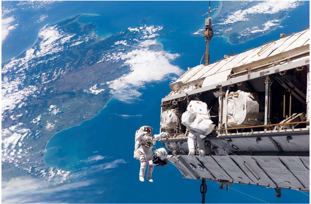
圖4. 2006年，太空人正在安裝桁架，桁架是用來安置太陽能板和艙外機器的結構。圖片來源：wiki
