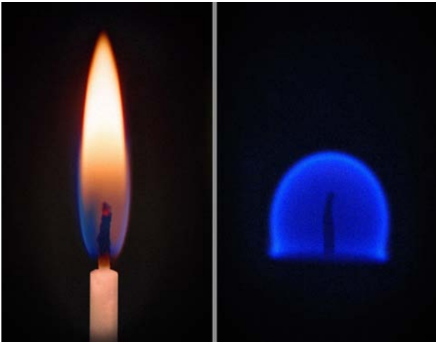
圖6. 左：在地表上的火焰形狀。右：在微重力環境下的火焰形狀。圖片來源：wiki
