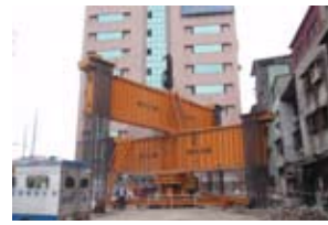
圖三十、環狀線CF650-CF651B標橋和站(Y12)樁載重試驗
