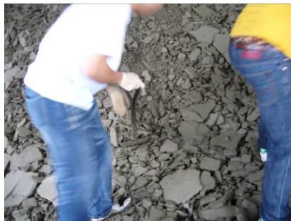
圖 4.1-1 淨水淤泥餅採樣實況
