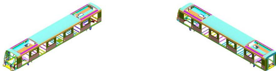
圖 2：測試 DM1 車車體結構之 3D 電腦模擬圖
